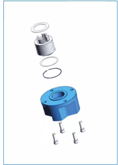
ISO втулка тип В без упорних підшипників
