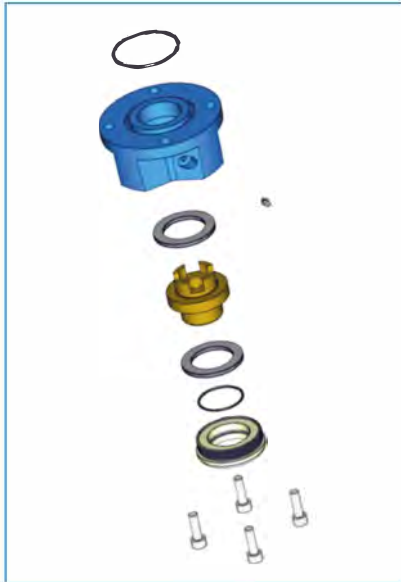
ISO втулка тип А з упорними підшипниками
