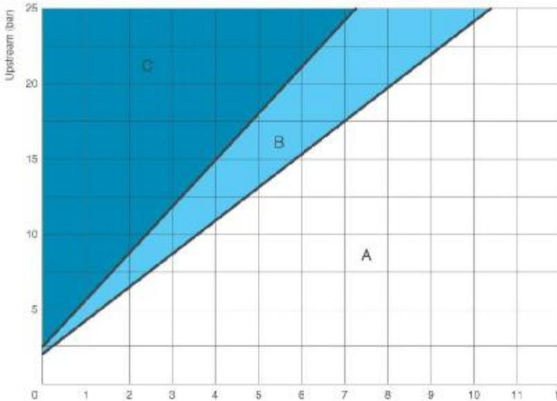
Аналіз умов виникнення кавітації дуже важливий, тому що вона може призвести до істотних пошкоджень, а також до вібрації і шуму. Кавітаційну діаграму необхідно використовувати для визначення положення робочої точки клапана, шляхом перетину лінії, що визначають тиск до клапана (ось y) та тиск після клапана (ось x). Робоча точка може знаходитися в одній з 3-х зон, що визначаються як:
