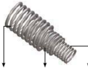
зовнішня пружина середня пружина внутрішня пружина
