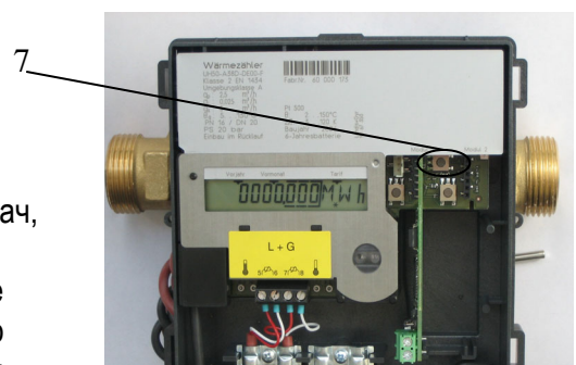
Рис.3 Теплообчислювач без верхньої кришки
