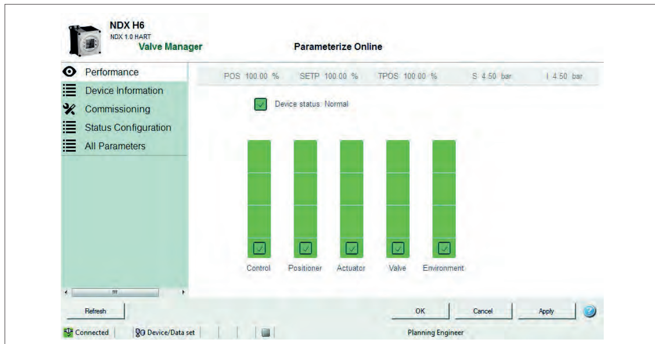
Мал. 2. У вікні «Продуктивність» програми Neles Valve Manager графічно відображаються стан клапана, привода і позиціонера а також індекси продуктивності керування та робочого середовища. У звіті будуть наведені пояснення щодо стану кожного компонента та вказівки щодо рекомендованих дій.
